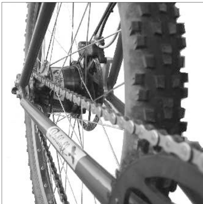
Rohloff SPEEDHUB 500/14 CC DB OEM montato s telaio con forcellini spostabili Rohloff OEM
