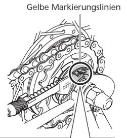
Auf der Schalteinheit sind gelbe Markierungslinien an zwei Stellen vorhanden. Verwenden Sie die Linie, die am einfachsten zu sehen ist.
