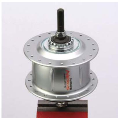
2. Bauen Sie die linke Kontermutter mit 14-mm-Nabenschlüsseln aus.
