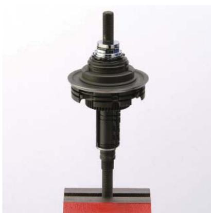
12. Demontieren Sie die rechte Kontermutter mit einem 17-mm-Nabenschlüssel.
