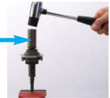
6. Montieren Sie die Antriebsscheibe. Die Scheibe muss so ausgerichtet sein, wie auf der Abbildung gezeigt.
