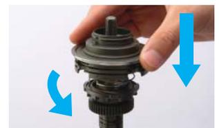
Befestigen Sie die Antriebseinheit durch Drehen gegen den Uhrzeigersinn.
