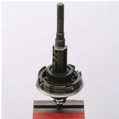
11. Bauen Sie das Käfig-Kugellager O (3/16" x 26) ein, während Sie die Sperrklinken der Antriebs- und Achseinheit drücken.
