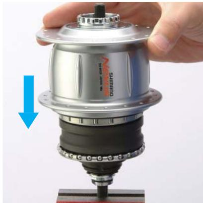
16. Setzen Sie das Käfig-Kugellager P (3/16" x 13) ins Nabengehäuse ein.
