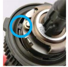
2. Montieren Sie die Rückstellfeder, indem Sie sie an der blauen Linie ausrichten, wie die Abbildung zeigt. Bauen Sie die Feder nicht verkehrt herum ein! Der größere Teil muss unten sein.
