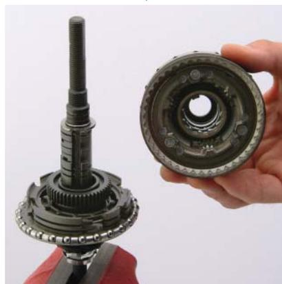
9. Entfernen Sie den Sicherungsring mit einem Schraubendreher.
